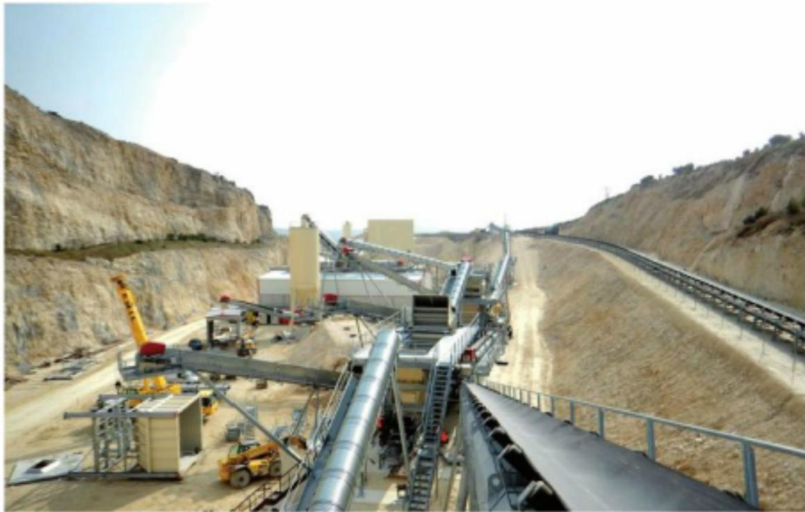
► Les convoyeurs à bande de la carrière ont des entraxes comprises entre 17 et 320 mètres / The belt conveyors of the quarry have lengths between 17 and 320 meters (doc. SMIL).
