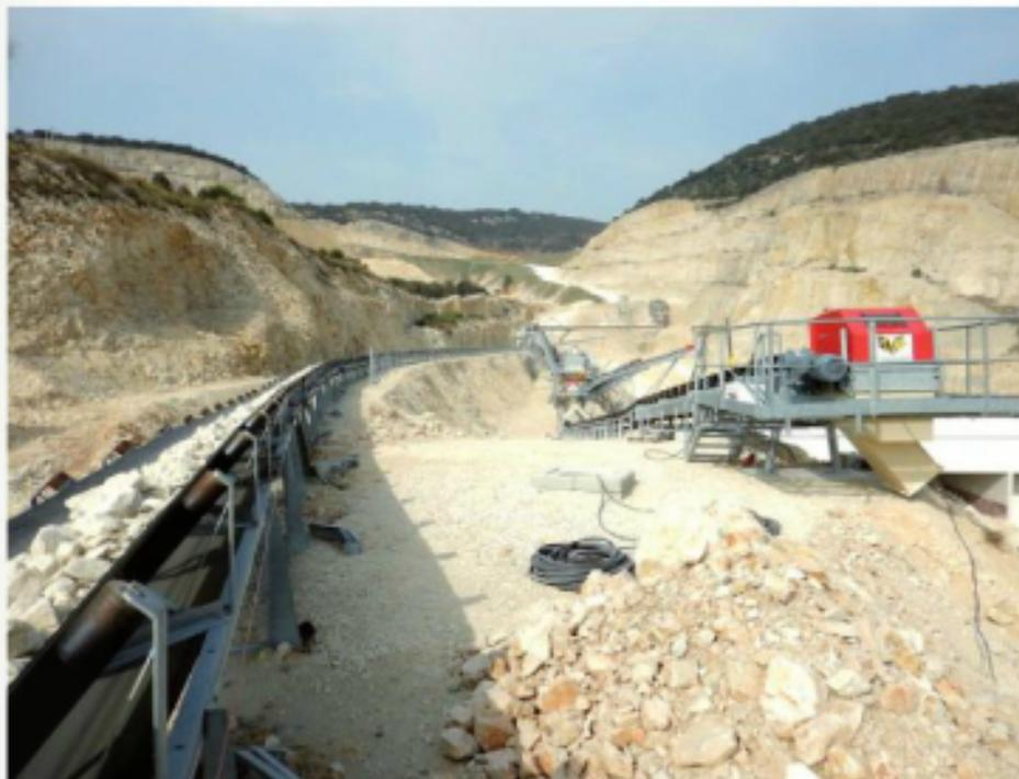
▶ La tête des convoyeurs a été équipée de façon à ce que les transferts de produits s'effectuent en limitant les émissions de poussières pour respecter l'environnement de la carrière / The conveyors head has been equipped for products transfers with reduced dust emissions to respect the quarry environment.
